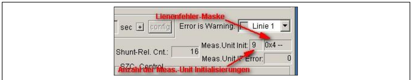
Abbildung 24: Ausschnitt Meas.Unit Init Counter und Meas.Unit IF Err Counter
