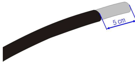
Abbildung 6: Abmanteln des CAT-Kabels
